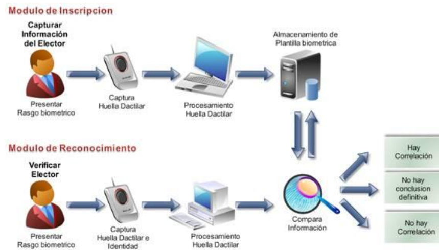
Figura 5. Proceso funcionamiento del sistema Biométrico.
