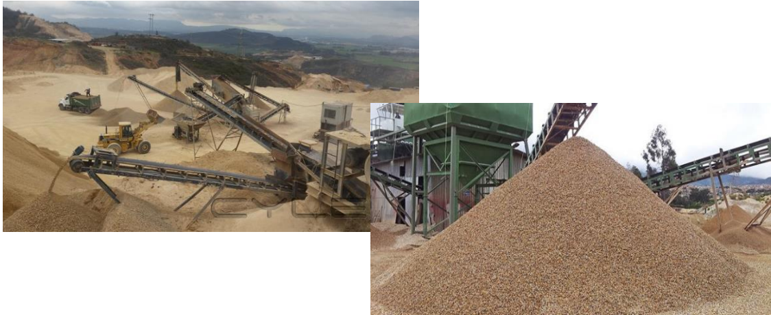
Ilustración 2 Triturado Lavado de Cantera de 3/4" y proceso de trituración – Fuente: www.agea.com.co/productos.html
