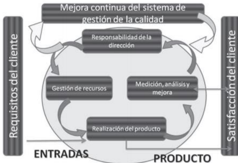
Gráfica1. Modelo de un sistema de gestión de calidad basado en procesos
