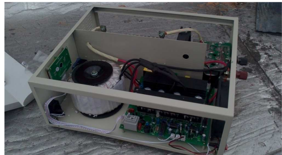
Imagen tomada en la universidad Militar Nueva granada caja inversora y reguladora.
