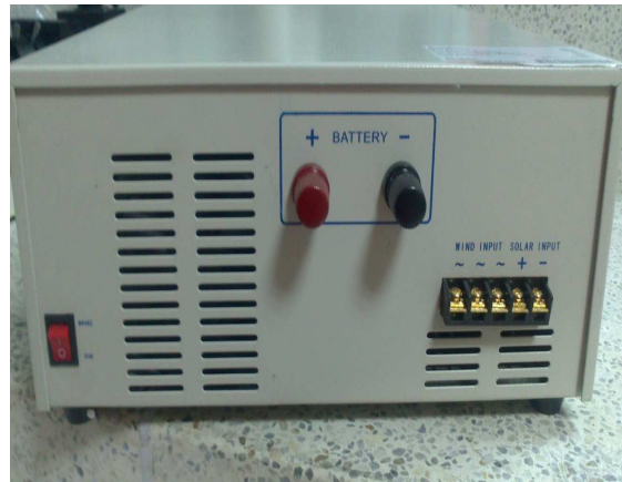
Imagen tomada en la universidad Militar Nueva granada caja inversora y reguladora.
