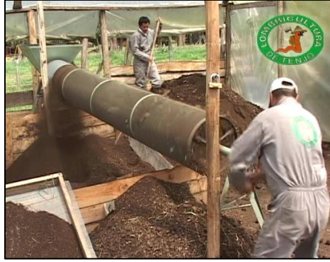
Ilustración 9. Máquina de construcción casera para limpiar el lombricompuesto Lombricultura de Tenjo [14]
