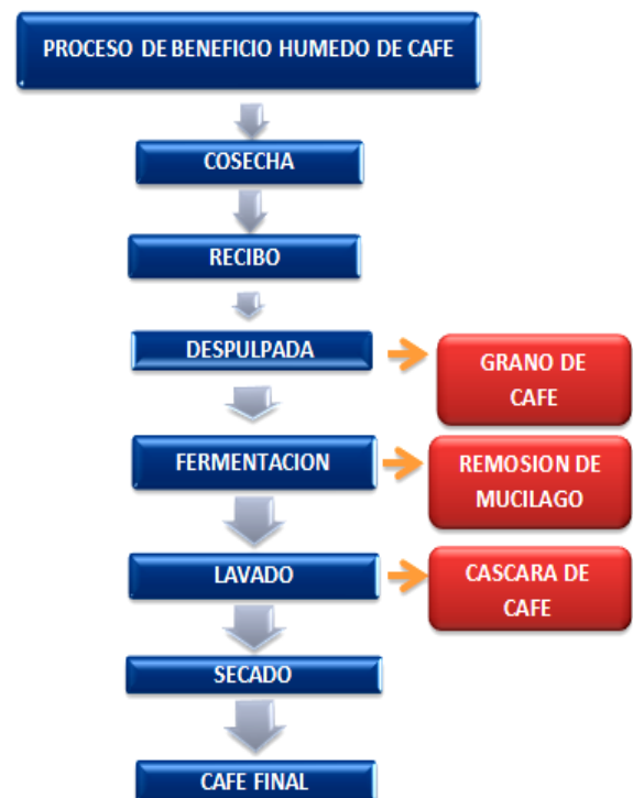
Figura 1: Diagrama de Flujo Beneficio Húmedo de café Fuente: Guía Ambiental para el sector cafetero
