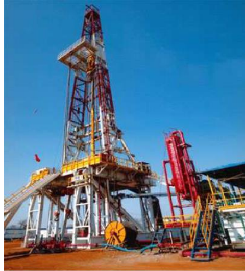
Figura 2 Taladro de perforación tomado de (Departamento de Ingeniería de petróleo, 2008).
