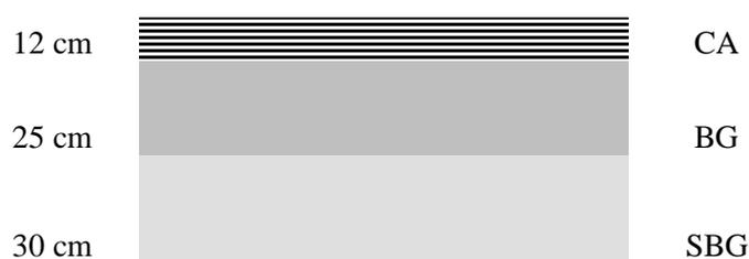
*Figura 11.* Estructura de Pavimento Propuesta.
