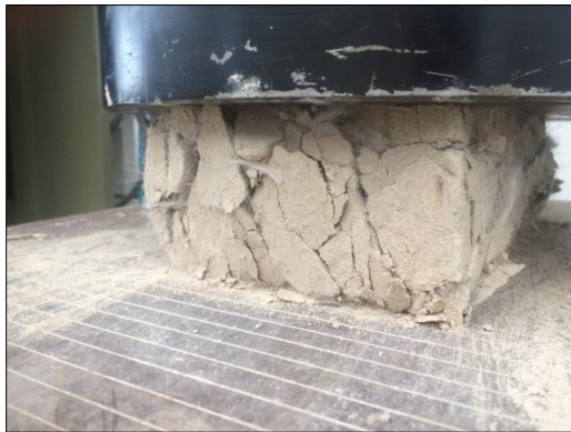
Imagen 34. Prueba de compresión con espécimen con 0.5% de PET. Fuente Autor
