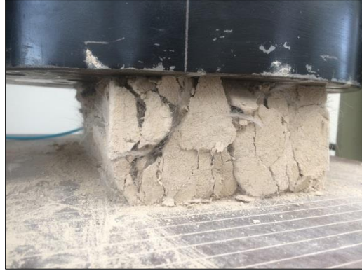
Imagen 35. Prueba de compresión con espécimen con 0.5% de PET. Fuente Autor.
