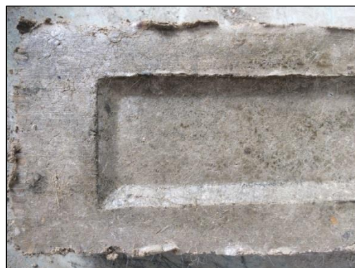
Imagen 17. BTC con 0.25 % de fibra PET. Fuente Autor.
