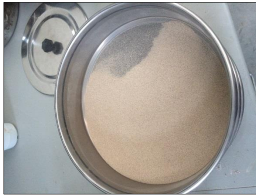
Imagen 46. Porcentaje retenido en Tamiz 0.15 mm. Fuente Autor.
