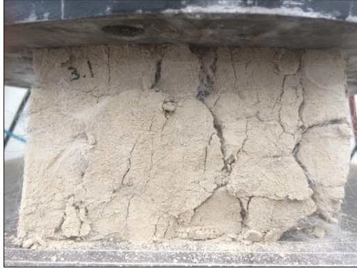
Imagen 40. Prueba de compresión con espécimen con 01% de PET. Fuente Autor.
