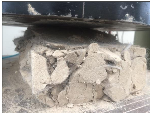
Imagen 37. Prueba de compresión con espécimen con 0.5% de PET. Fuente Autor.
