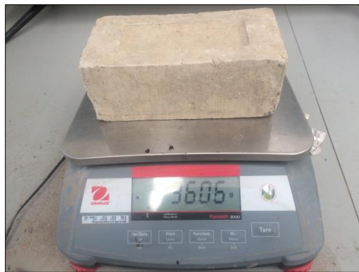
Imagen 23. Bascula para pesaje de especímenes. Fuente Autor.
