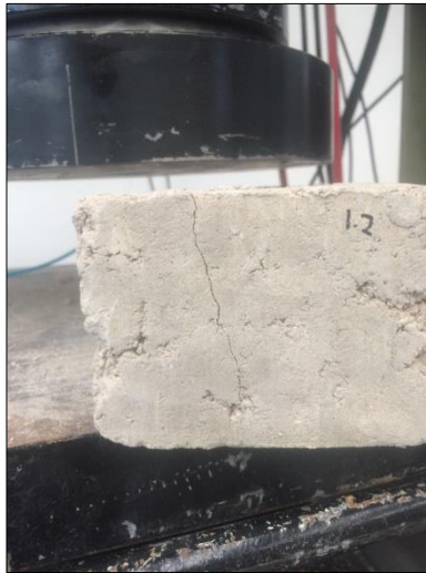
Imagen 29. Tipo de falla de bloque sin fibra. Fuente Autor.
