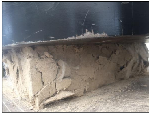
Imagen 36. Prueba de compresión con espécimen con 0.5% de fibra PET. Fuente Autor.
