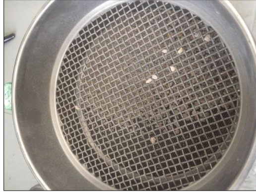
Imagen 42. Porcentaje retenido en Tamiz 4.7 mm. Fuente Autor.
