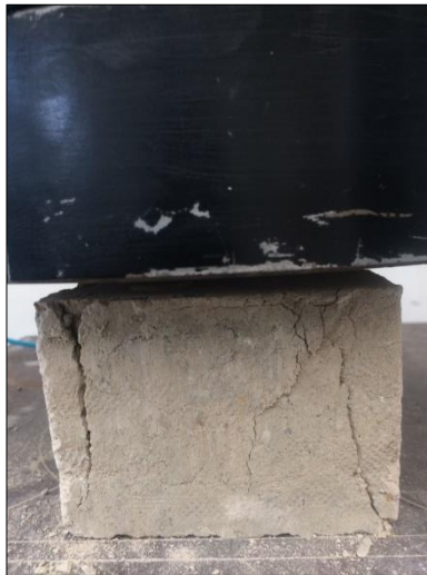
Imagen 31. Falla a compresión bloque sin fibra. Fuente Autor.
