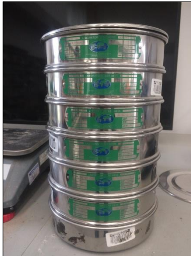
Imagen 41. Juego de tamices para granulometría. Fuente Autor.
