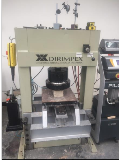
Imagen 28. Prensa para ensayo de compresión. Fuente Autor.
