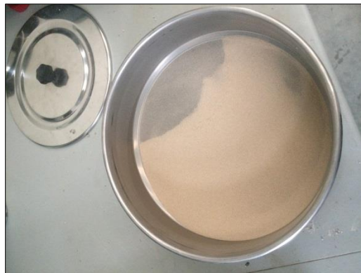
Imagen 47. Porcentaje retenido en Tamiz 0.075 mm. Fuente Autor.
