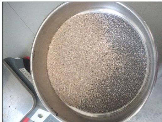
Imagen 44. Porcentaje retenido en Tamiz 0.6 mm. Fuente Autor.
