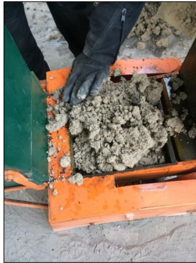
Imágen 10. Fabricación de BTC. Fuente Autor.
