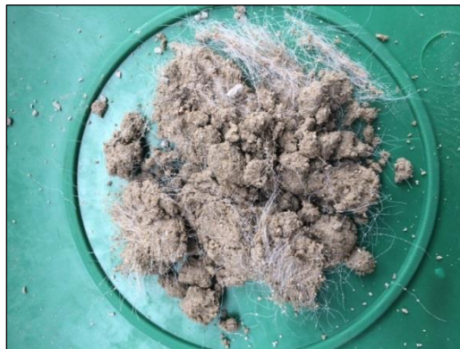
Imagen 14. Material con adición de fibra. Fuente Autor.
