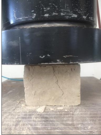
Imagen 30. Compresión espécimen con 0% PET. Fuente Autor.
