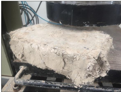
Imagen 39. Prueba de compresión con espécimen con 1% de fibra PET. Fuente Autor.
