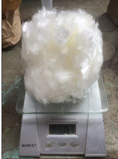
Imagen 12. Báscula para pesar la fibra. Fuente Autor.
