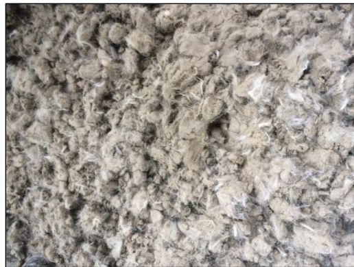
Imagen 19. Material para BTC con 0.5 % de fibra PET. Fuente Autor.
