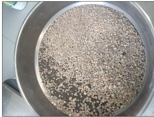
Imagen 43. Porcentaje retenido en Tamiz 1.19 mm. Fuente Autor.
