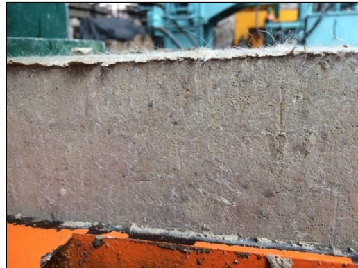
Imagen 16. BTC con 0.25 % de fibra PET. Fuente Autor.
