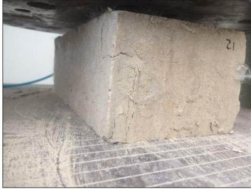
Imagen 32. Ensayo a compresión bloque con 0.25% de PET
