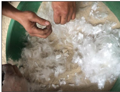
Imagen 13. Adición de fibras de PET. Fuente Autor.
