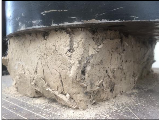
Imagen 38. Prueba de compresión con espécimen con 1% de PET. Fuente Autor.
