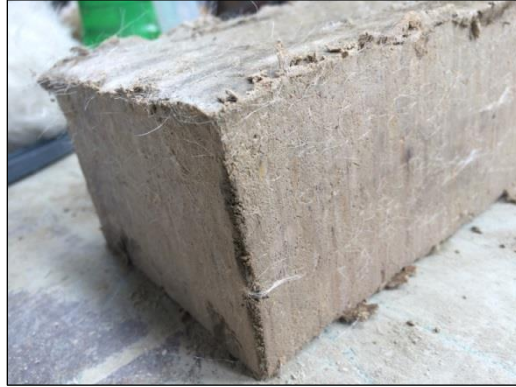
Imagen 18. BTC con 0.25 % de fibra PET. Fuente Autor.
