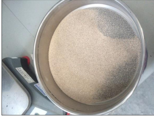
Imagen 45. Porcentaje retenido en Tamiz 0.3 mm.
