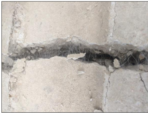
Imagen 33. Fibras en Bloque con 0.25% de fibra PET. Fuente Autor.
