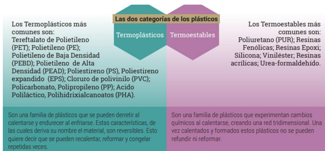
Figura 1. Las dos categorías principales de los plásticos. Adaptado de "PLÁSTICOS DE UN SOLO USO: Una hoja de ruta para la sostenibilidad" por ONU Medio Ambiente, 2018.
