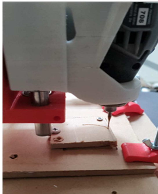
Figura 20. CNC trabajando sobre madera.
