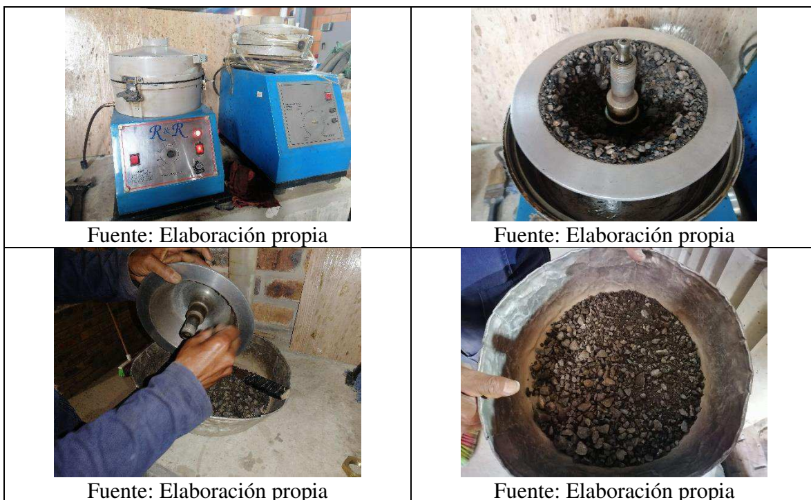
Figura 19. Ensayo de extracción cualitativa de asfalto
