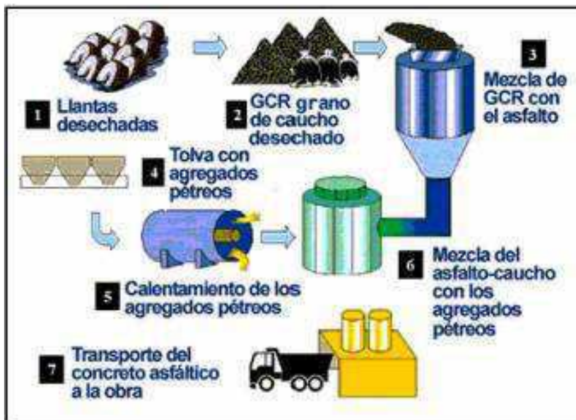
Figura 7. Proceso por vía húmeda
