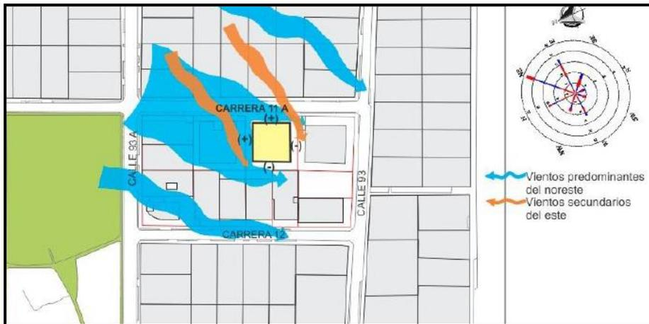
**Figura 4.** Ventilación natural en la ubicación del proyecto en Bogotá. Imagen obtenida de: Estudio Bioclimático de Edificio Torre Uno 93.
