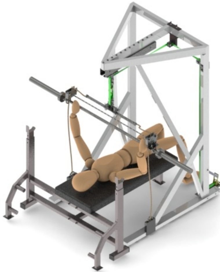
Figura 3-64.: Renderizado del diseño mecánico, ubicado en el contexto dónde ejercería sus funciones en conjunto con el levantador y el equipo para prensa de banco. El modelo de equipo para prensa de banco, a escala real, fue desarrollado por A.Yousefi [?] (el color fue modificado), y el muñeco de proporciones humanas fue elaborado por S.Winther [?] (escalado para representar las medidas de una persona de 1.80m). Imagen elaborada por el autor mediante la herramienta de renderizado de "Solidworks".
