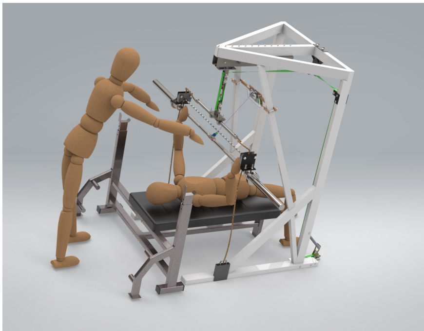
Figura 3-75.: Aspecto final del sistema de seguridad para el ejercicio hipertrófico de la prensa de banco. Imagen elaborada por el autor mediante la herramienta de renderizado de Solidworks.
