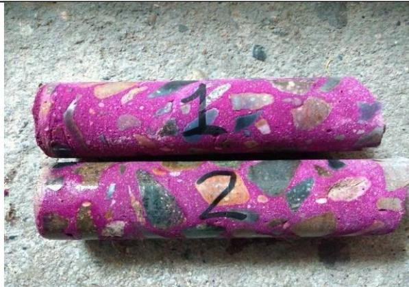
Fotografía 28 Muestras después de ensayo de carbonatación
