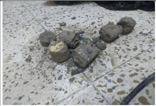
Fotografía 29 Muestra fallada durante el proceso de extracción
