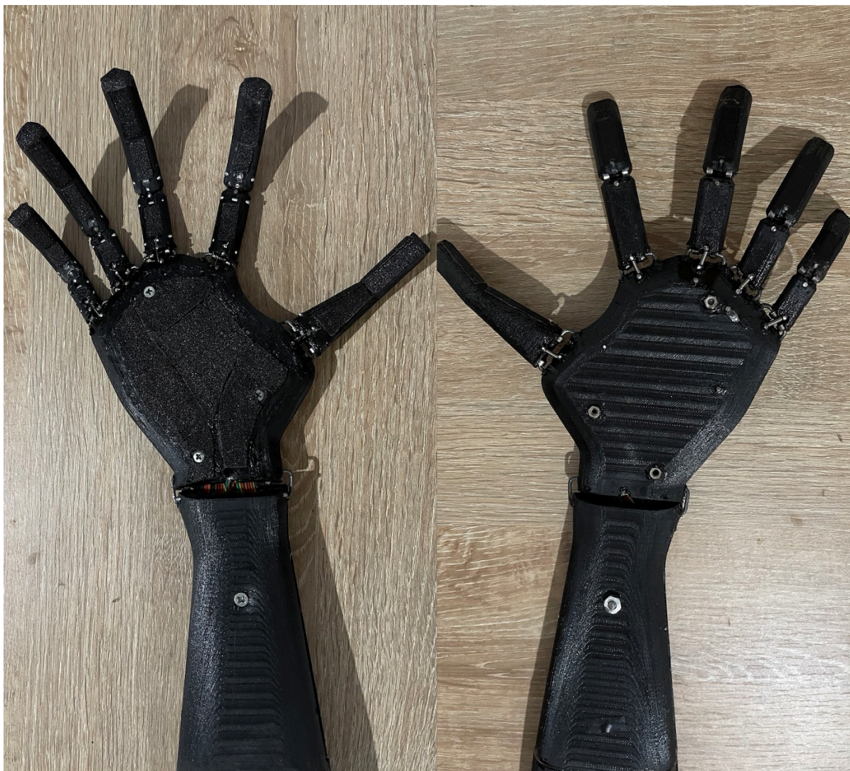
Figura 4-17.: Vista frontal y posterior, se detalla el uso de papel de lija Número 80.
