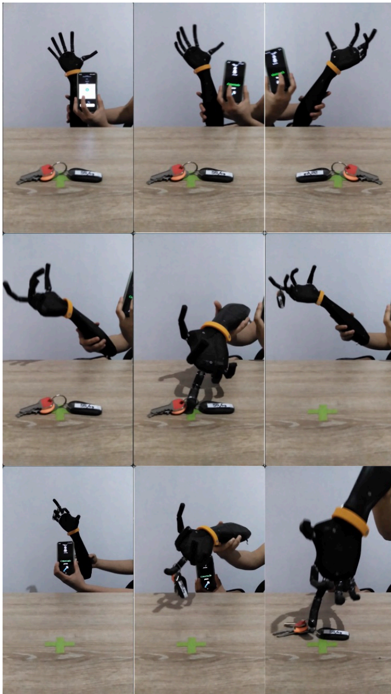
Figura 4-24.: Prueba final de movimiento "PISTOLA" llaves de 35,6 gramos.
