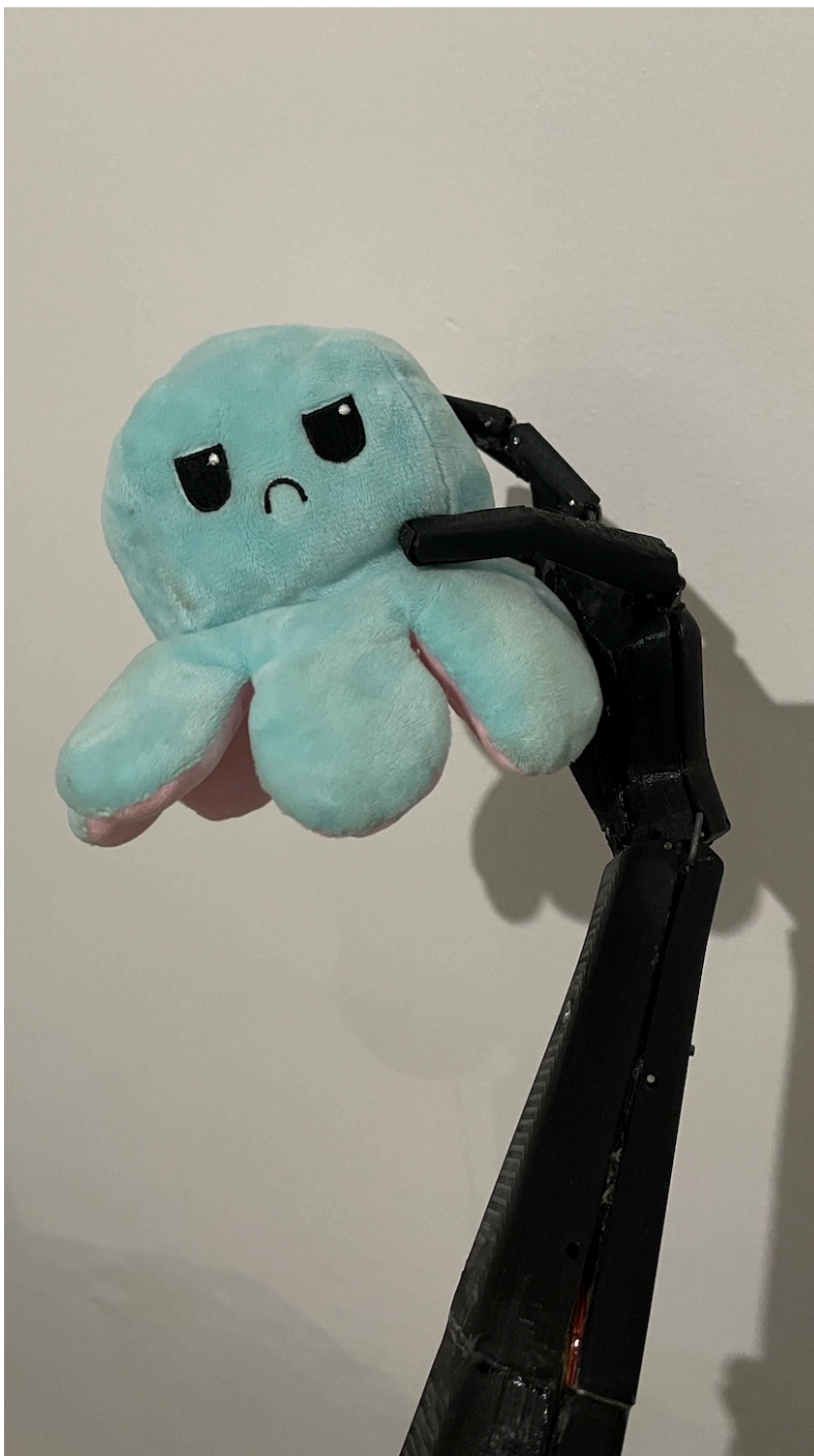
Figura 4-22.: Prueba de agarre autónomo con inclinación ( "AGARRE" con "FLEXIÓN de muñeca" ) .
