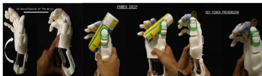
Figura 1-18.: De izquierda a derecha: dorsiflexión de la muñeca, agarre de poder, prensión de pellizco de llave [11].
