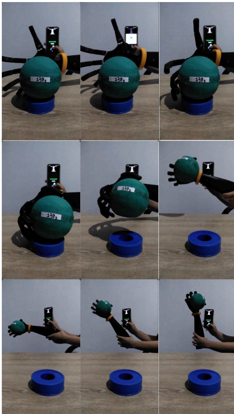
Figura 4-29.: Prueba final, patrón de agarre "BOTELLA" bola de 17,8 gramos.
