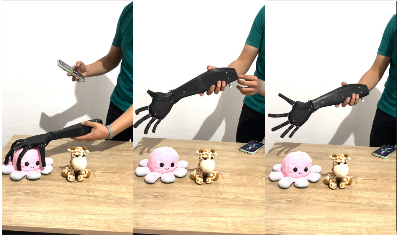
Figura 4-9.: Reconocimiento de comandos de voz y ejecución parcial de patrones de agarre.
