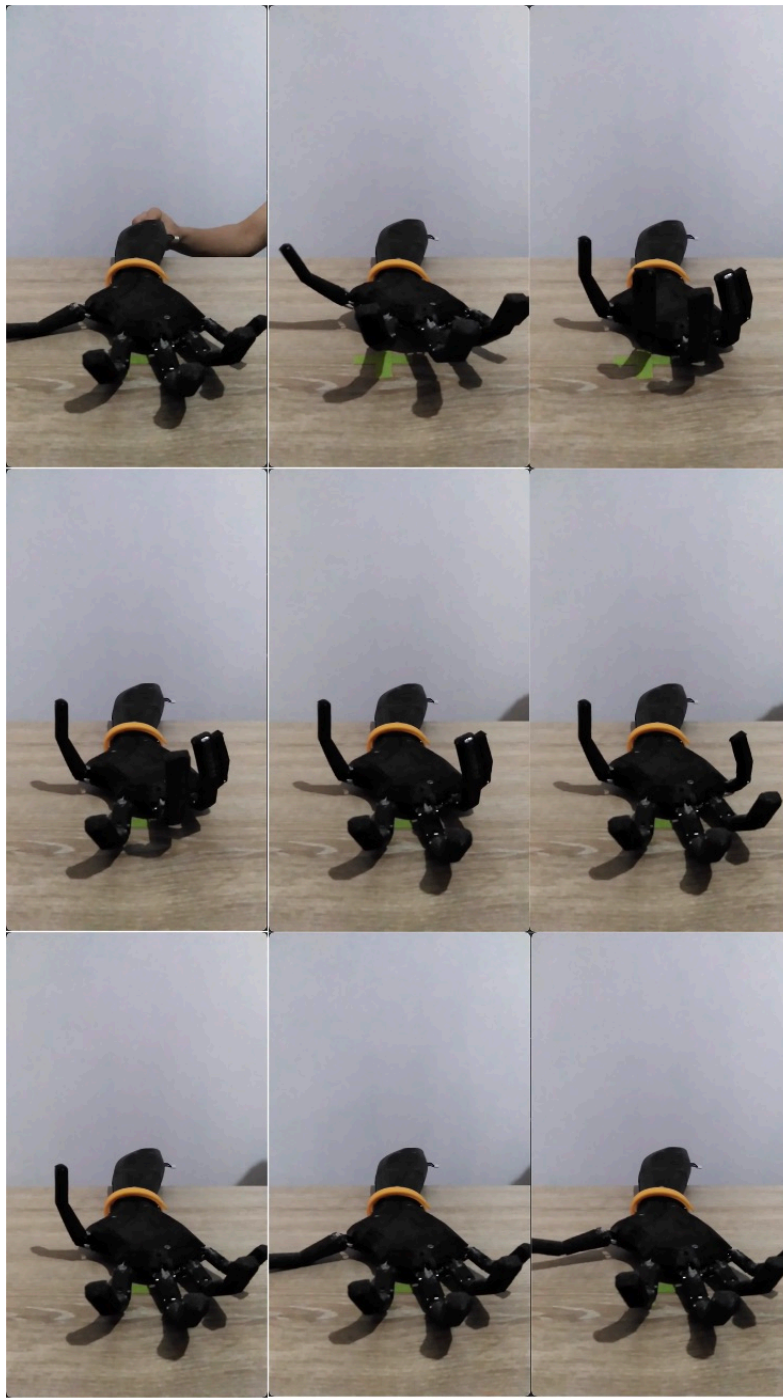
Figura 4-32.: Prueba final de calibración de los 7 actuadores (posición inicial "HOME").
