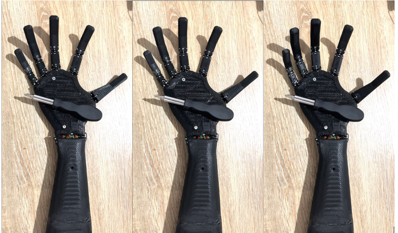
Figura 4-5.: "EXTENSIÓN" de muñeca con elemento de superficie lisa de 45g.
