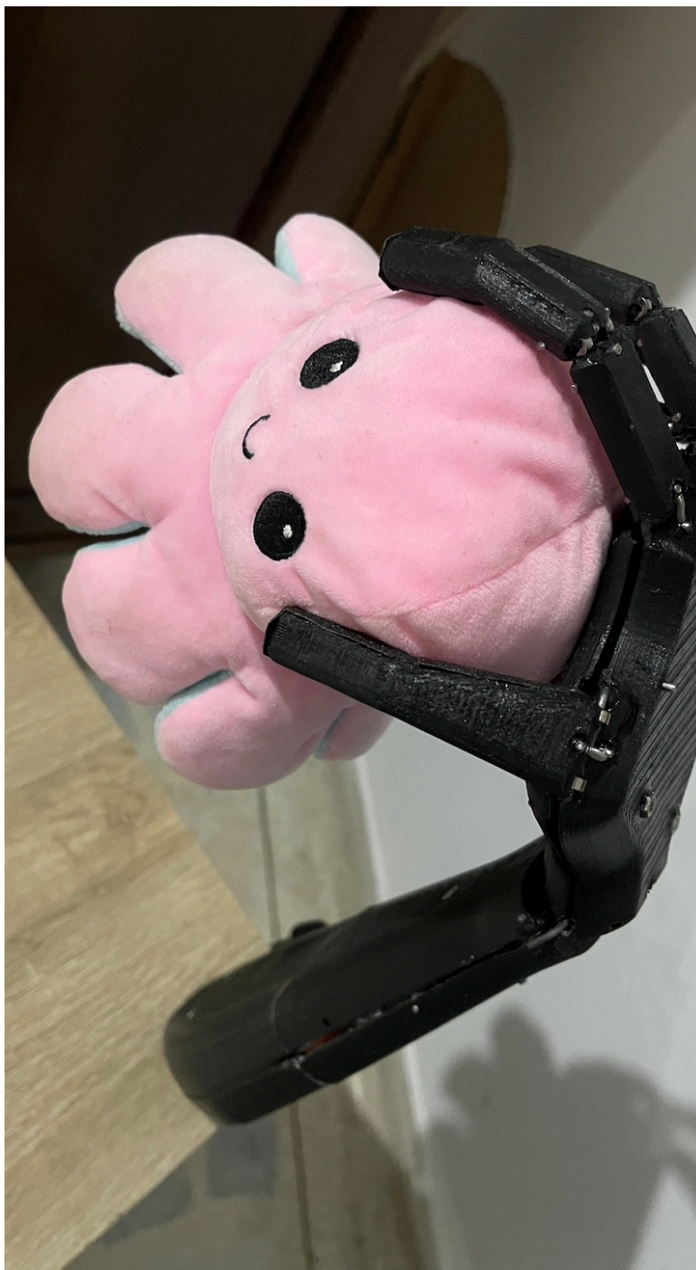
Figura 4-21.: Prueba de agarre autónomo( "AGARRE" con "FLEXIÓN de muñeca") .
