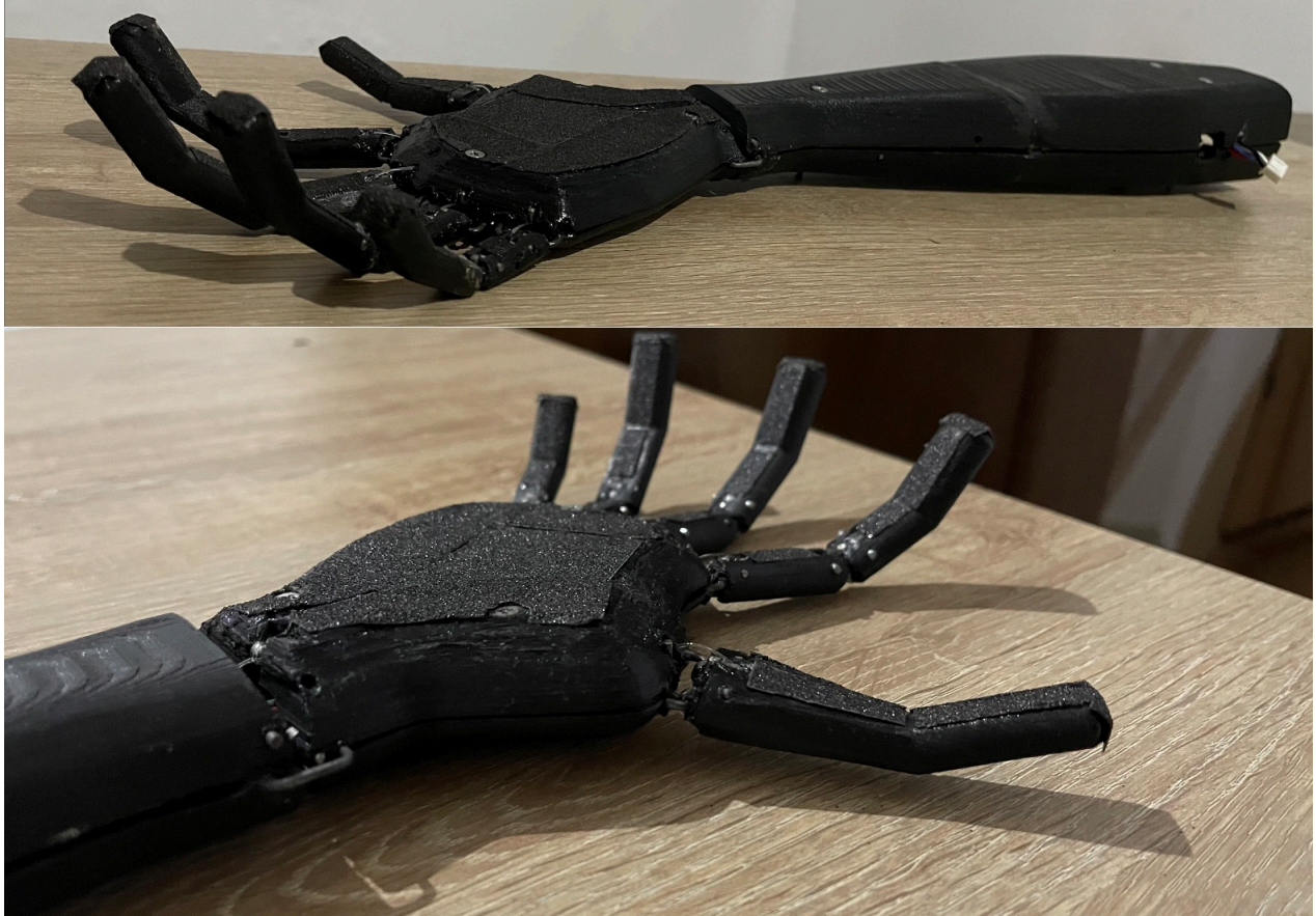
Figura 4-18.: Vistas isométricas, se detalla el uso de alambre galvanizado para el sistema de pivote.
