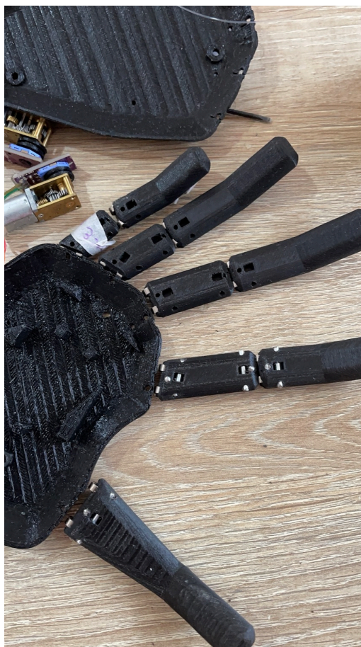
Figura 3-32.: Palma inferior impresa con las falanges superpuestas.
