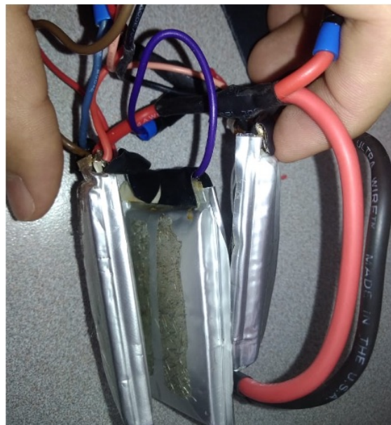
Figura 1-35.: Baterías Li-Po 1S infladas y conexiones en mal estado [19].
