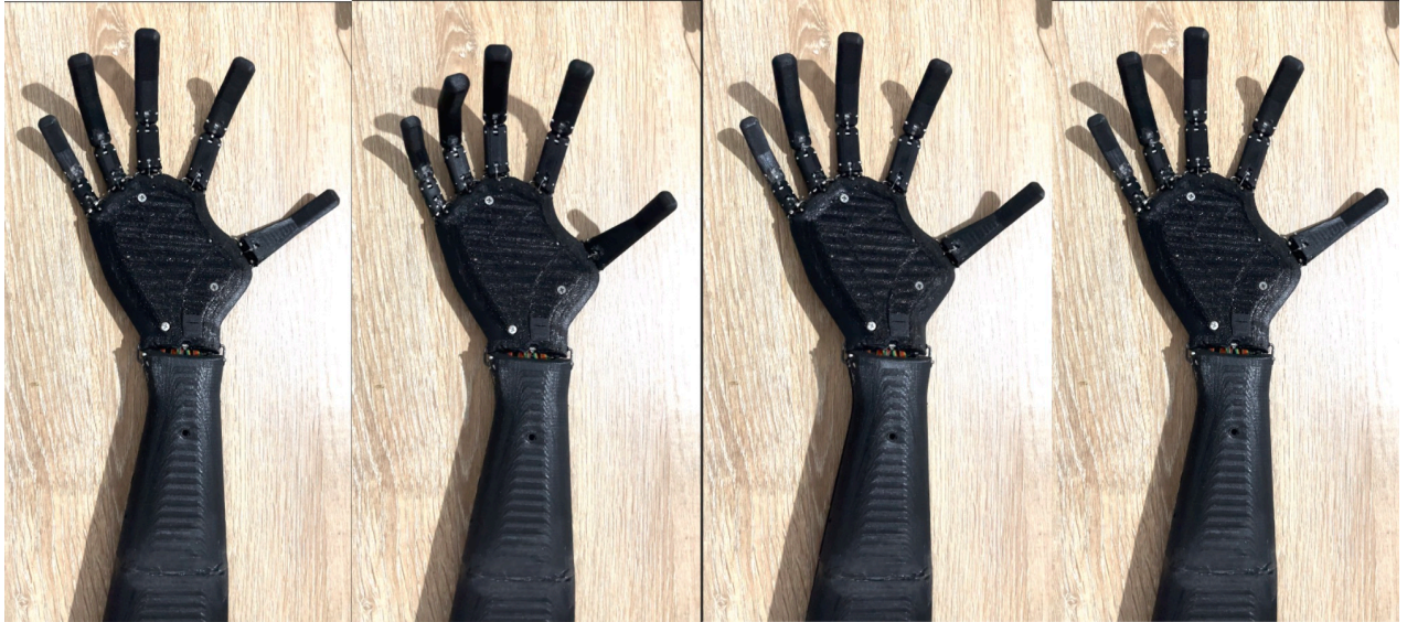
Figura 4-4.: Movimientos secuenciales en los dedos y respuesta de la muñeca ("EXTENSIÓN").
