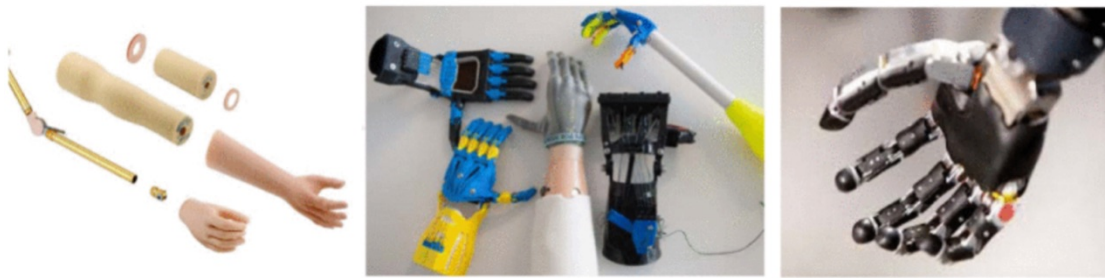
Figura 2-2.: Tipos de prótesis según su accionamiento de izquierda a derecha: prótesis pasiva, prótesis accionada por el cuerpo y prótesis robótica [11].
