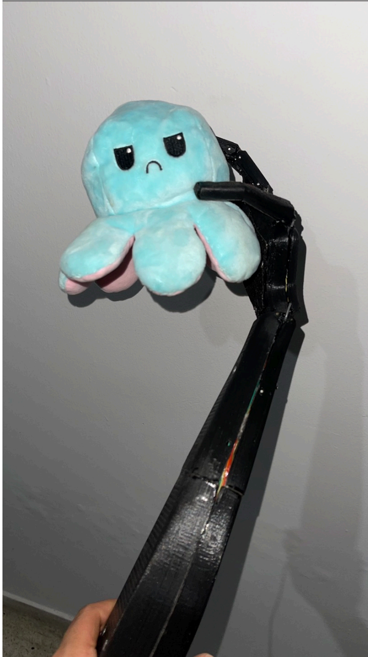
Figura 4-19.: Prueba de agarre puntual "AGARRE" con "FLEXIÓN de muñeca" (Peluche 20cmx20cmx10cm).
