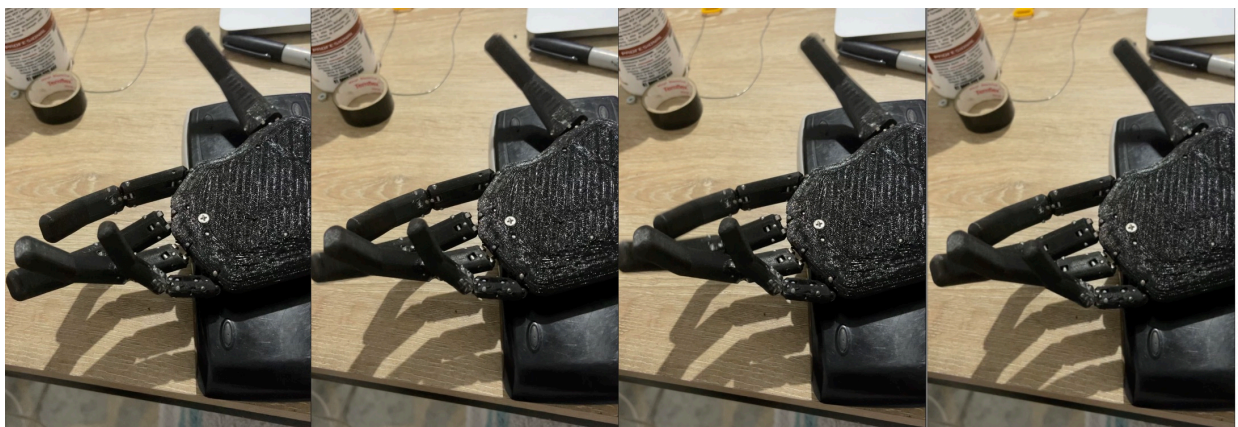
Figura 4-2.: Respuesta oscilatoria de los dedos.
