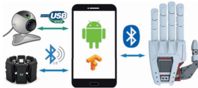
Figura 1-26.: Diagrama de bloques de la interacción entre los diferentes dispositivos del sistema [17].
