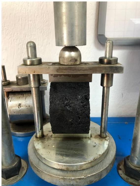
*Figura 18* Briqueta sometida a ensayo de tracción indirecta
