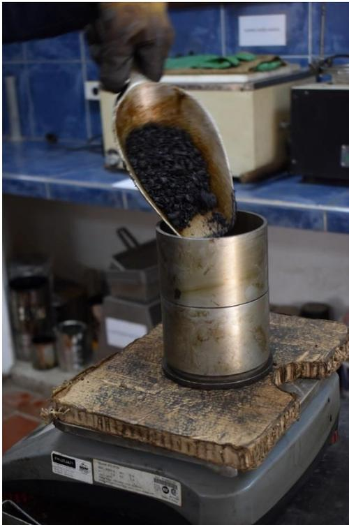
*Figura 7* Vaciado de la mezcla en el molde
