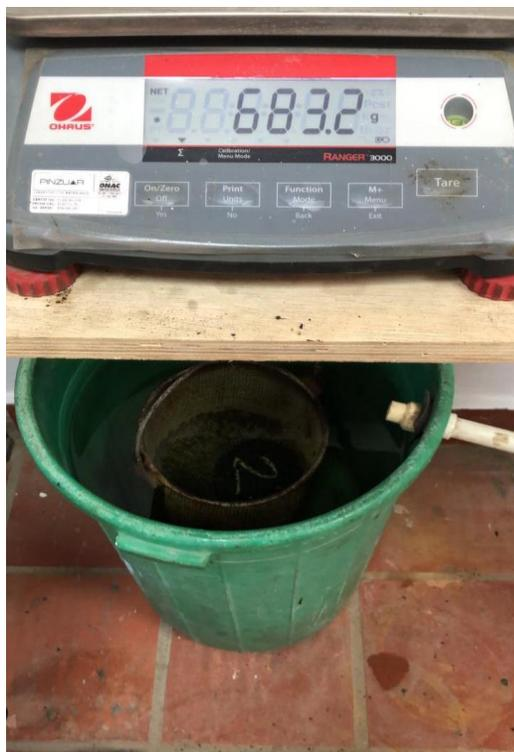
Figura 13 Determinación de la gravedad específica bulk
