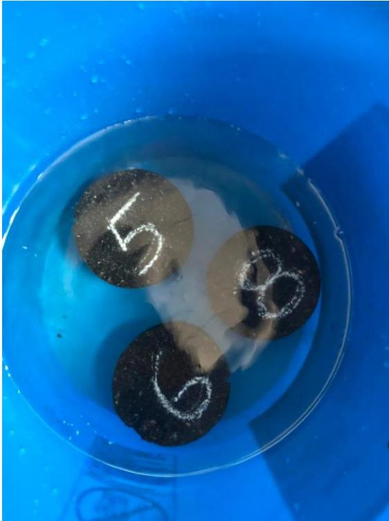
*Figura 14* Acondicionamiento de las briquetas en seco
