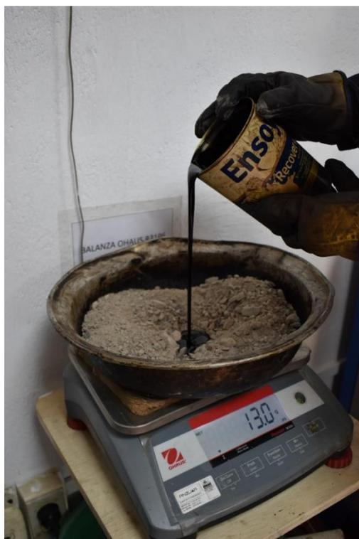
*Figura 5* Dosificación del cemento asfáltico
