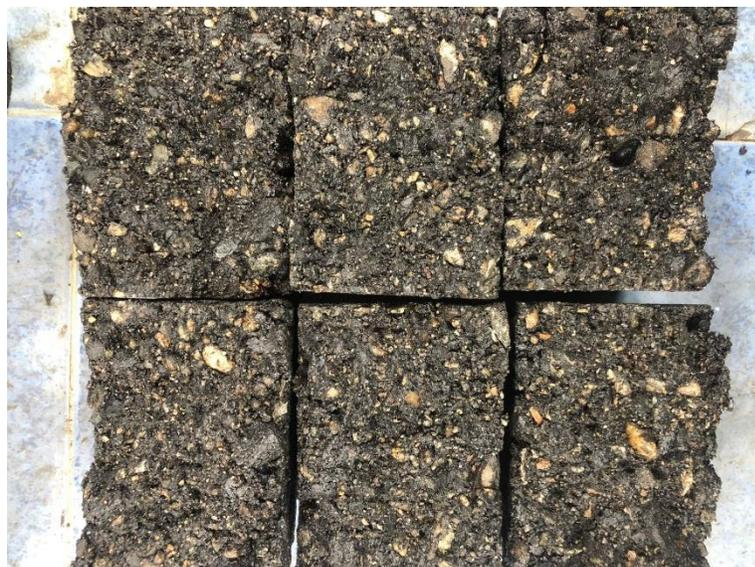
*Figura 19* Briquetas falladas
