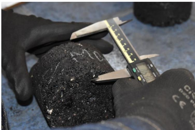
Figura 12 Medición con pie de rey de la briqueta
