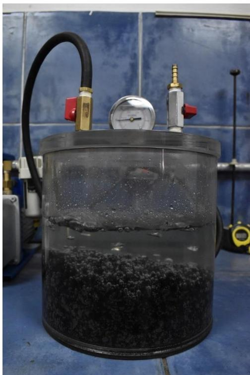
*Figura 9* Determinación de gravedad específica máxima medida
