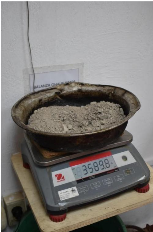
*Figura 3* Dosificación del material
