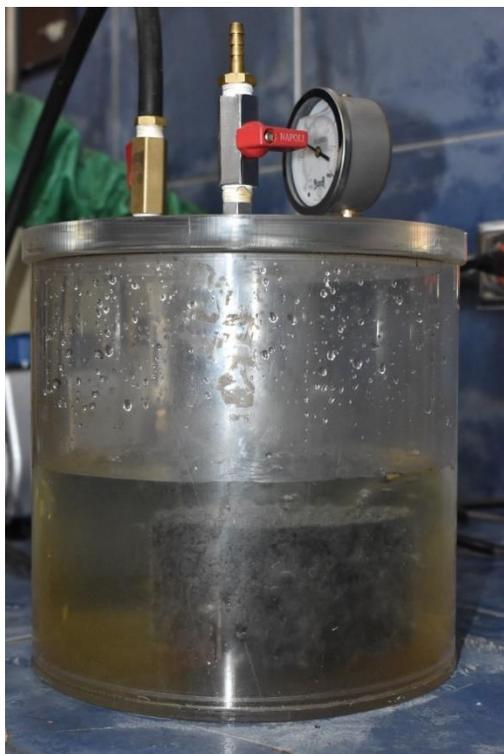
*Figura 16 Saturación de la briqueta*
