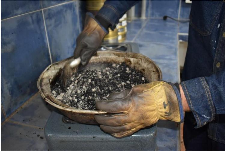
*Figura 6* Mezclado del agregado y cemento asfáltico
