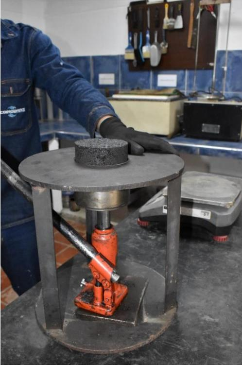
*Figura 10* Extracción de briquetas
