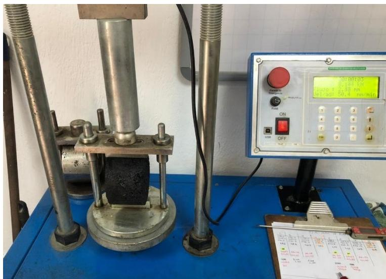
Figura 15 Briqueta sometida a ensayo de tracción indirecta
