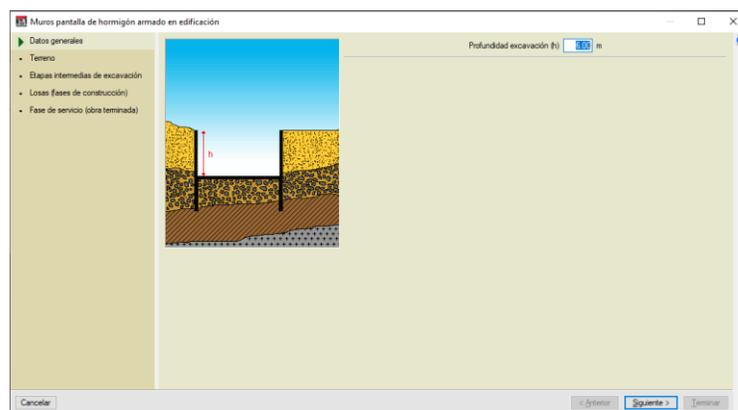
**Profundidad de excavación:** varía en función de la cantidad de sótanos del modelo. Los casos en estudio abarcan modelos de cuatro sótanos. La diferencia de nivel de losas de sótanos es de 3,25 m para cada caso. La profundidad de excavación fijada incluye 1,00 m adicional de excavación, considerándolo para efectos constructivos de la losa de cimentación. A continuación, se exponen las profundidades de excavación para cada modelo según el número de sótanos:
