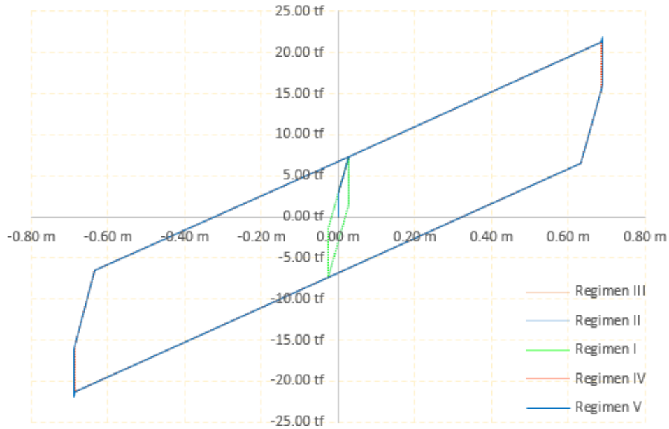
Figura 104. Curva Bilineal Histerética Aislador TFP - Tipo 2 (Microzona Lacustre 200). Fuente: Propia.
