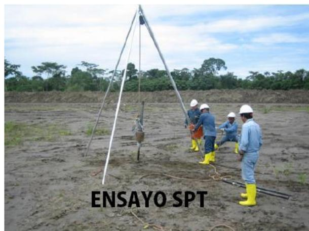
**Ilustración 11. Ejemplo de Ensayo SPT. Fuente: ingenieriaymas.**
