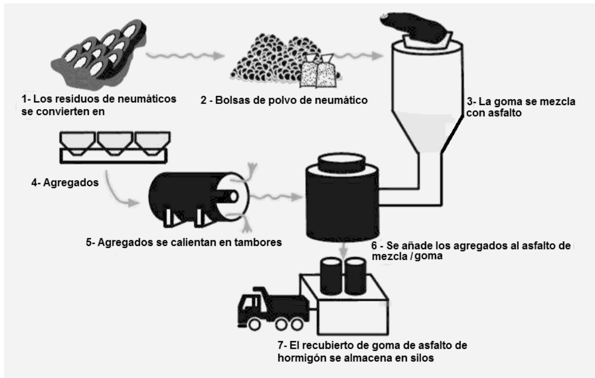
Figura 3. Proceso elaboración grano de caucho reciclado y asfalto modificado
