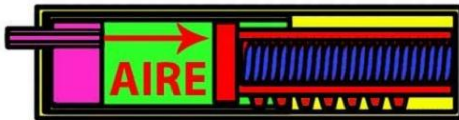
Figura 18. Esquema de forma de inyección de aire dentro del sistema de la caja de engranajes de DNA AEG. Tomado de Echeverry (2009)
