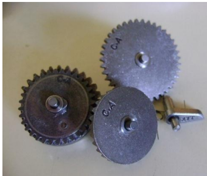
Figura 14. Ruedas dentadas de una caja de engranajes de DNA AEG. Tomado de Echeverry (2009)
