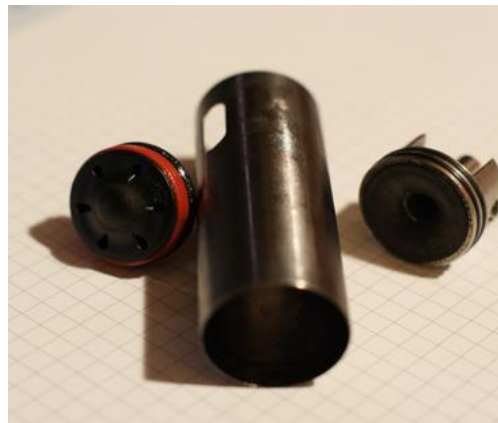
Figura 12. Boquilla de Aire y su posición en el cilindro de una caja de engranajes de DNA AEG. Tomado de Echeverry (2009)
