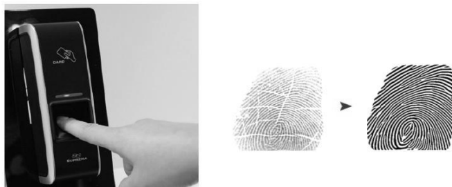
Figura 1. Captura de huella en Lectora Bioscrypt. Fuente: Bioentry Plus.
