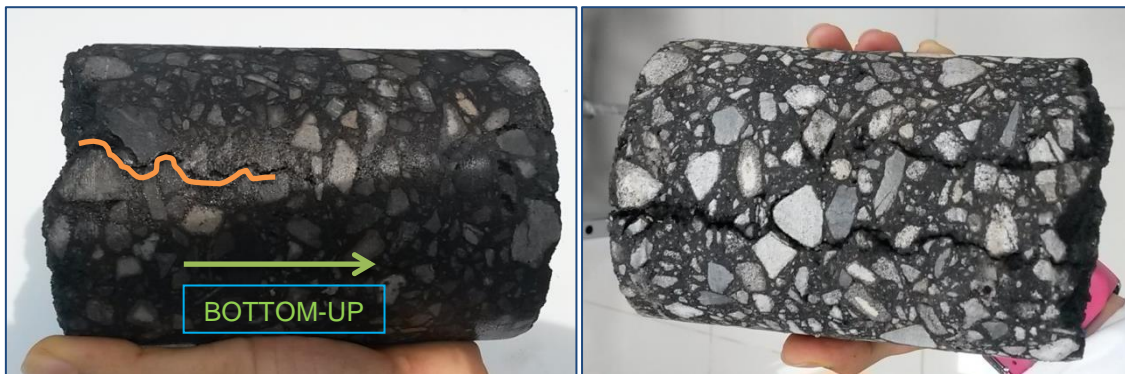
Imagen 15. Núcleos 2 y 3. a) Núcleo 2 en la abscisa K1+340. b) Núcleo 3 en la abscisa K2+200.
