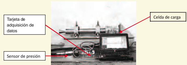
FIGURA 3: Banco de pruebas con los sensores instalados.
