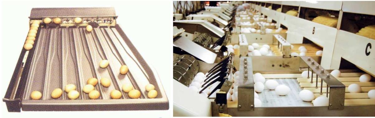
**Figura 4.** Máquinas de selección y clasificación de huevo
