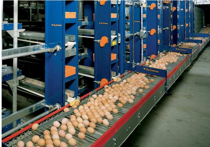
**Figura 3.** Sistema de recolección de huevo en galpón automatizado
