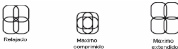
Figura 4. Grados de libertad de un eslabón
