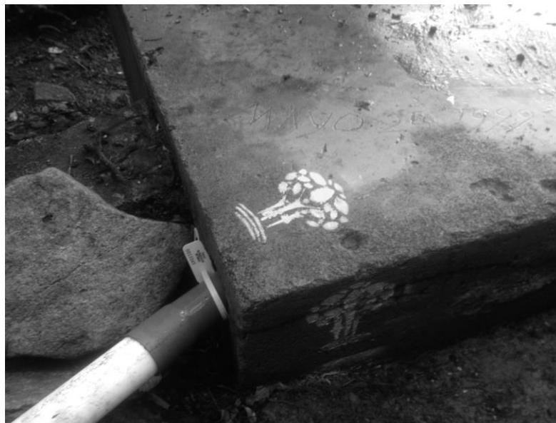
Figura 12. Demarcación de un punto vértice con precinto de seguridad en un predio. Fuente: Unidad de restitución de tierras. 2014.
