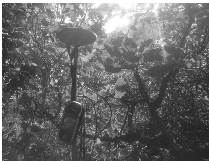
Figura 10. Equipo GPS con precisión submétrica marca Ashtech®. Fuente: Unidad de restitución de tierras. 2014.
