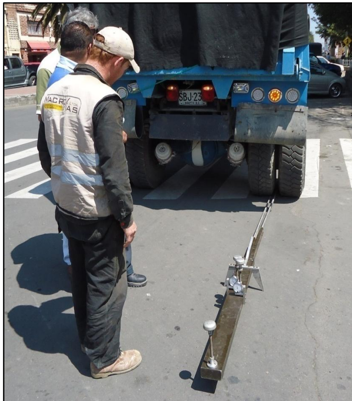
Ilustración 29. Registró fotográfico toma de deflexiones con Viga Benkelman. Fuente: Propia laboratorio
