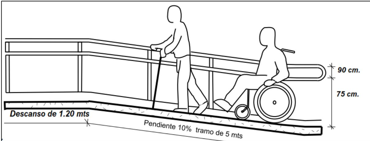
**Figura 33:** Esquema de una rampa
