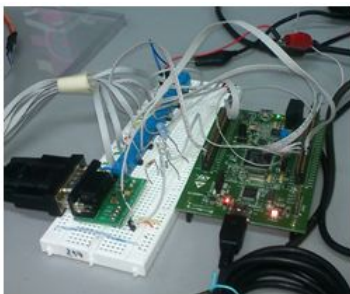
Figure 12. Circuito General del Manipulador de 5DOF, Fuente: Registro Fotográfico - Autor
