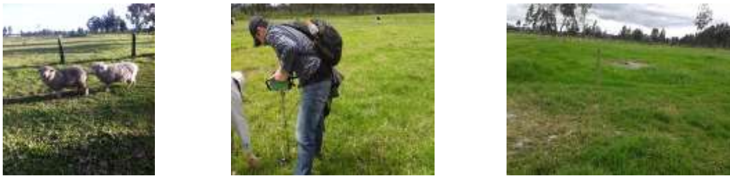
Figura 3. Toma de Puntos de Resistencia a la Penetración en diferentes lotes de CAM – Mosquera – Cundinamarca, Colombia Fuente: Elaboración propia
