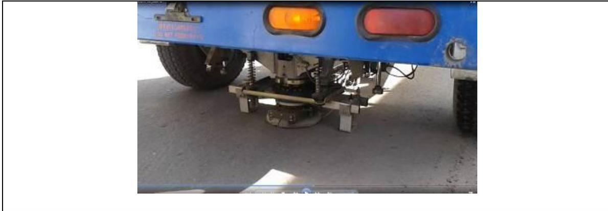
Fotografía No. 3. Ejecución ensayo deflectometría
