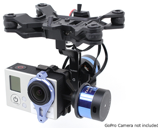
Figura 2.6: Gimbal y cámara ejemplos de carga útil indispensable [14]
