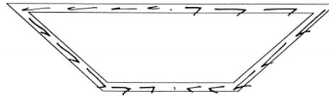
*Figura 18. Flujo de cortante viaja a través de sus paredes*
