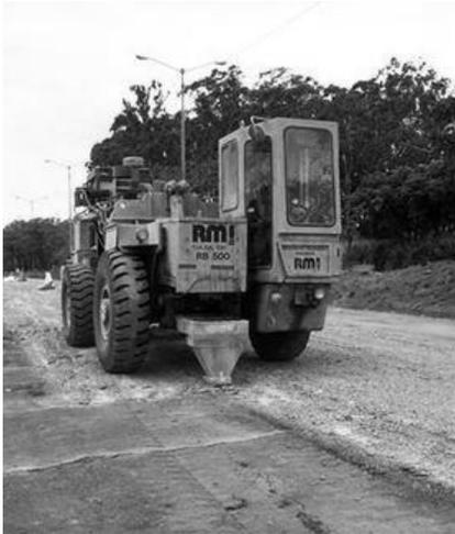
**Figura 3.** Equipo rompedor resonante.
