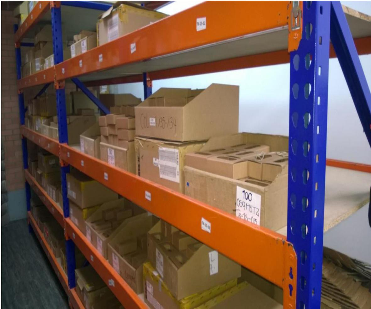
**Figura 1. Almacenamiento recomendado (Racks con pintura electro estatica)**
