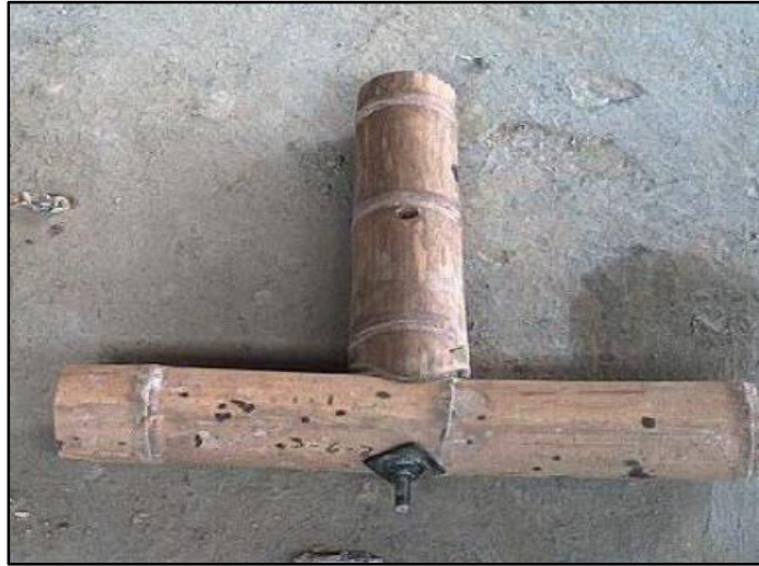
Figura 1: Unión tipo Simón Vélez Modificado a 90°
