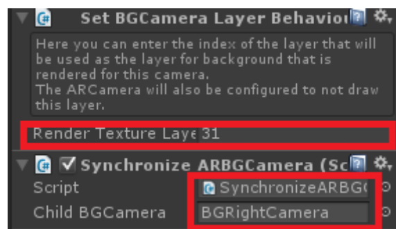
Figura 3 Capa de renderizado de la cámara, scripts y cámara asignada como hija
