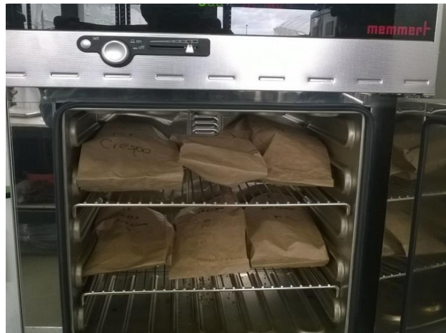
Figura 16. Horno de secado con el material de romero empacado en bolsas de papel para obtener biomasa seca de romero. Tomada por: Cañón, 2014.
