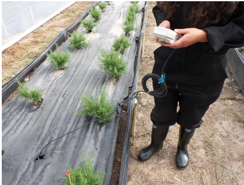
Figura 13. Uso del Dispositivo Thetra Probe ®, en el sustrato del ambiente bajo invernadero, cuantificando la cantidad de humedad presente en este.
