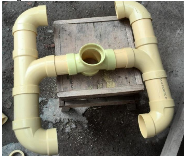
Ilustración 31 Fotografía - Construcción de flotador en PVC sanitario de 2"
