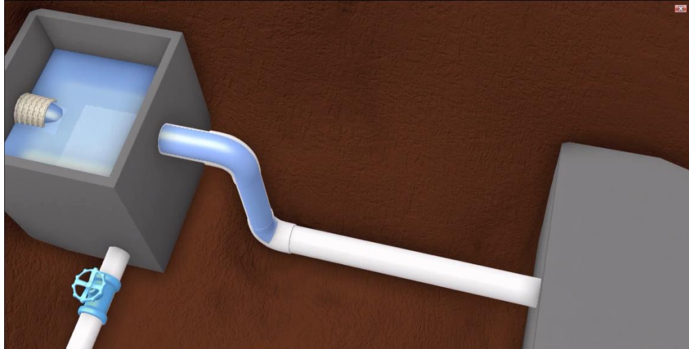
Ilustración 55 Instalación tubería 4" PVC presión
