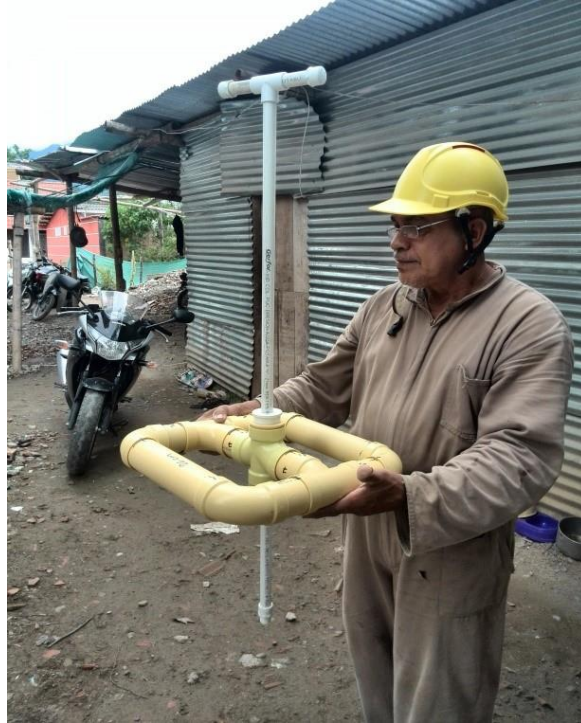
Ilustración 32 Fotografía Flotador en PVC sanitario de 2”
