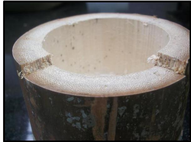
*Figura 39.b. Falla típica del ensayo de corte paralelo*
