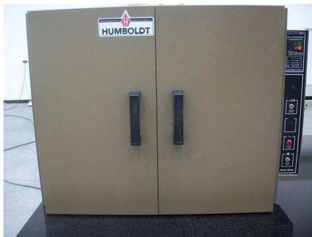
*Figura 16. Horno de secado marca HUMBOLDT®
