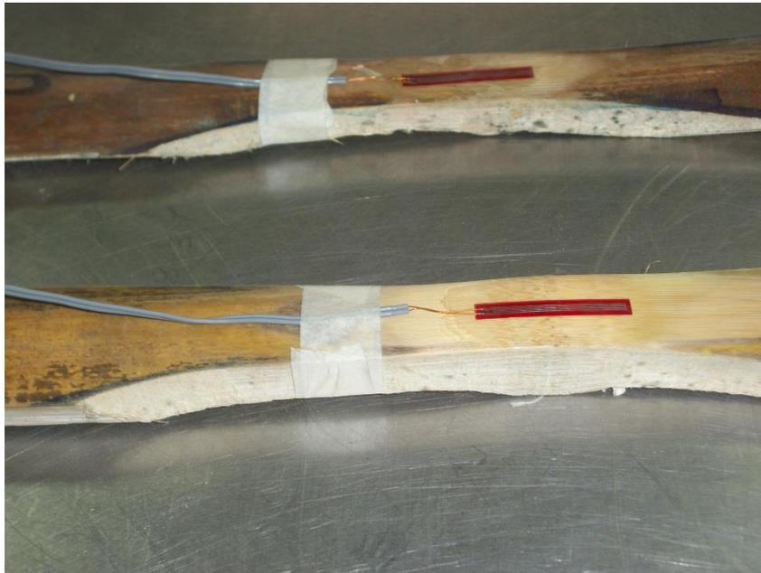
**Figura 63.** Probetas para ensayo a Tensión zona Pacho.
