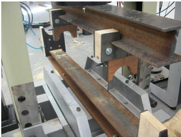
*Figura 21. Dispositivo metálico para ensayo de flexión Fuente: el autor*
