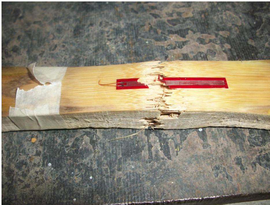
*Figura 68. Fallas presentadas en las probetas de ensayo a tensión*
