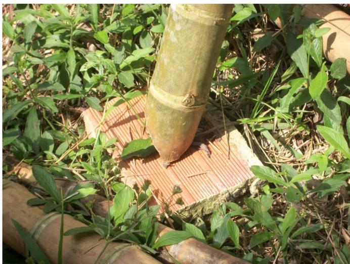
*Figura 10. Apoyo del culmo de guadua luego del corte, para evitar humedad del suelo. Fuente: el autor*
