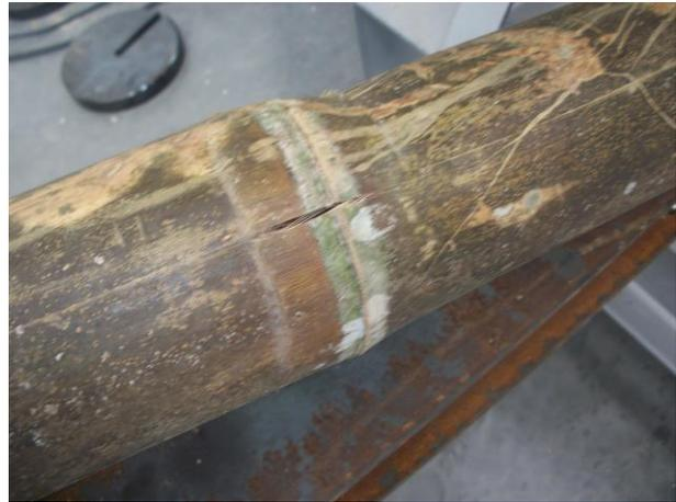
*Figura 60. La falla por corte se presentó en el centro del culmo*
