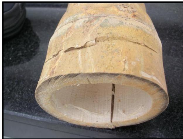
*Figura 41. Falla por corte en probeta de ensayo a flexión*
