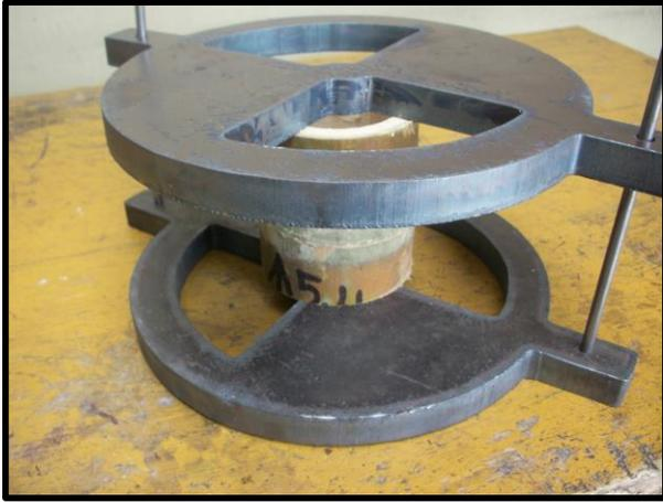
*Figura 37. Probeta sobre dispositivo de corte*
