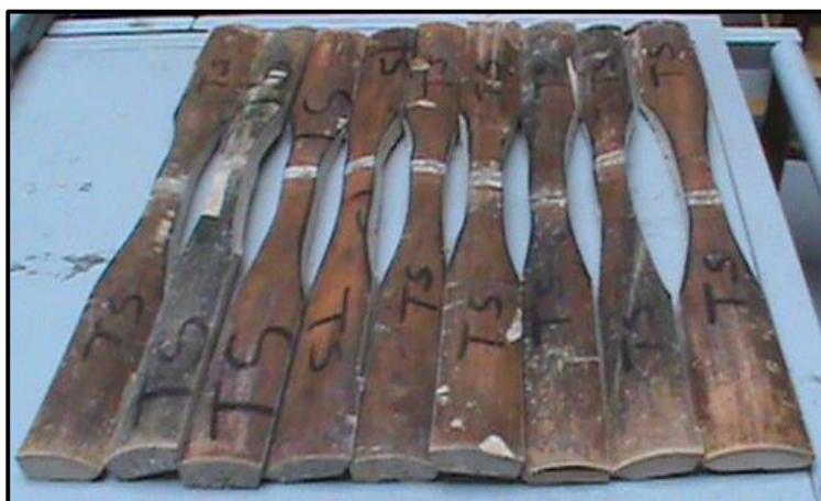
**Figura 44.** Probetas para ensayo a Tensión zona Silvania.
