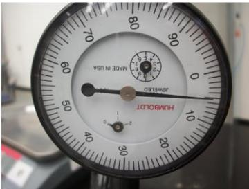
**Figura 23.** Deformímetro mecánico
