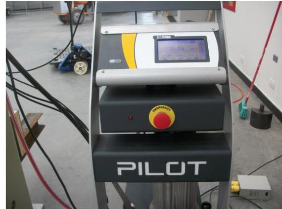
**Figura 18.** Control electrónico para la máquina de carga Fuente: el autor
