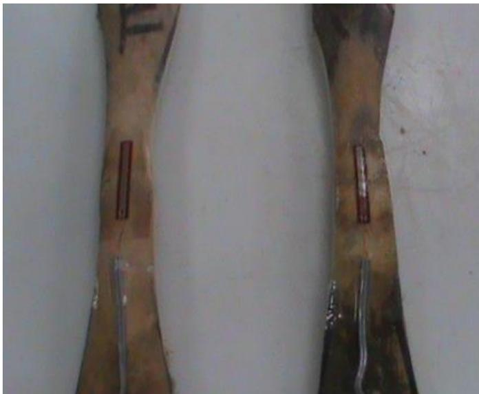
*Figura 47. Pegado de las galgas extensométricas*
