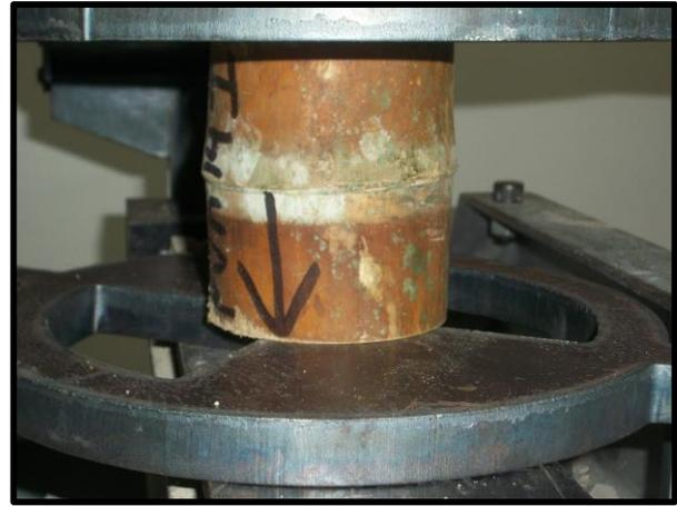
*Figura 38. Probeta de guadua en ensayo de corte paralelo*
