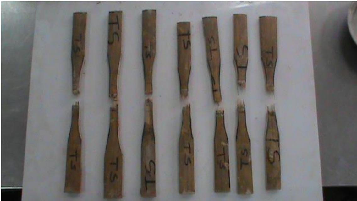
*Figura 49. Fallas presentadas en las probetas de ensayo a tensión*
