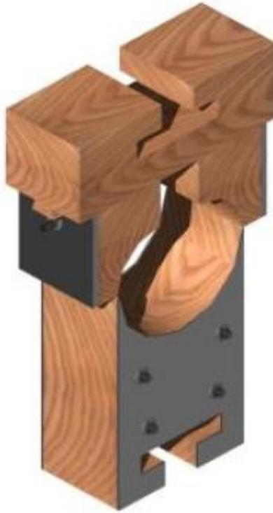
*Gráfica 21 Vista 3D. Dispositivo de apoyo y de carga.
