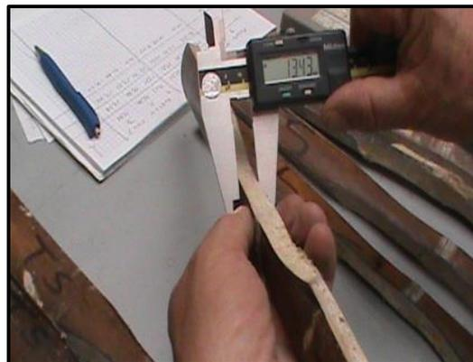
*Figura 65. Determinación del grosor de la probeta para tensión*
