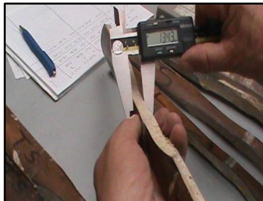
*Figura 46. Determinación del grosor de la probeta para tensión*
