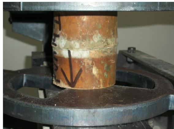
**Figura 20.** Dispositivo con la probeta de guadua lista para ser fallada Fuente: el autor
