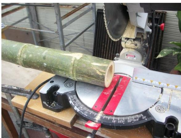
*Figura 14. Acolilladora para corte de guadua con disco de tungsteno. Fuente: el autor*
