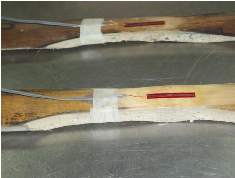
*Figura 66. Pegado de las galgas extensométricas*
