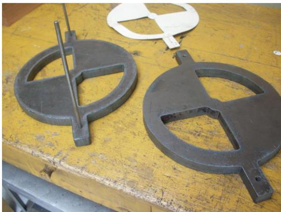
**Figura 19.** Dispositivo metálico para ensayo de corte paralelo Fuente: el autor
