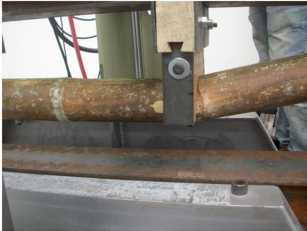
*Figura 59. Falla por corte en ensayo a flexión*
