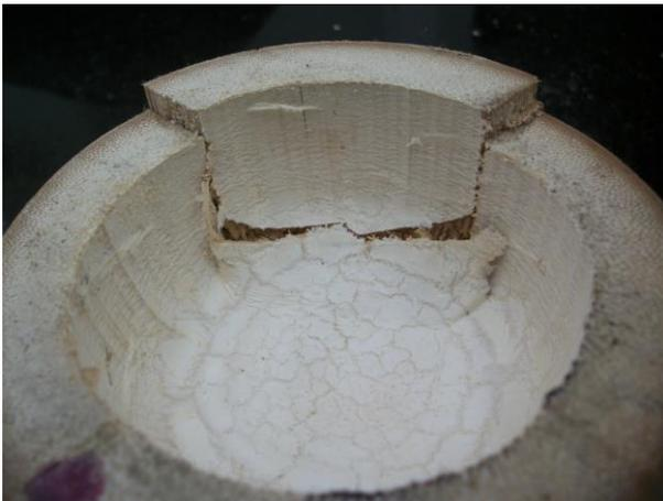
*Figura 39.a. Falla típica del ensayo de corte paralelo*
