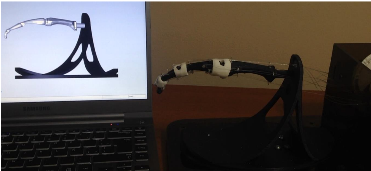
Figura 71 Sincronización dedo virtual y dedo antropomórfico
