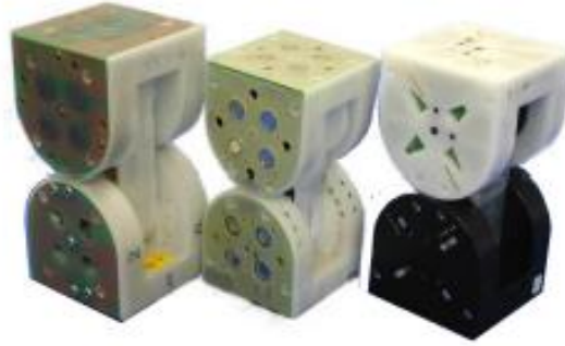
Figura 3-14 Comparación entre las tres generaciones de M-TRAN M-TRAN I (izquierda), M-TRAN II (centro) M-TRAN III (derecha) Tomado de: (Kamimura, Kokaji, Kurokawa, Tomita, & Yoshida, 2005)
