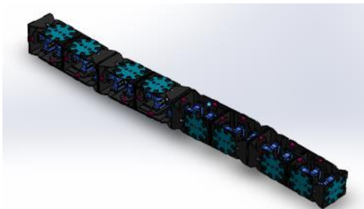
Figura 4-14 Conexión Centro - Centro en configuración serpiente.
