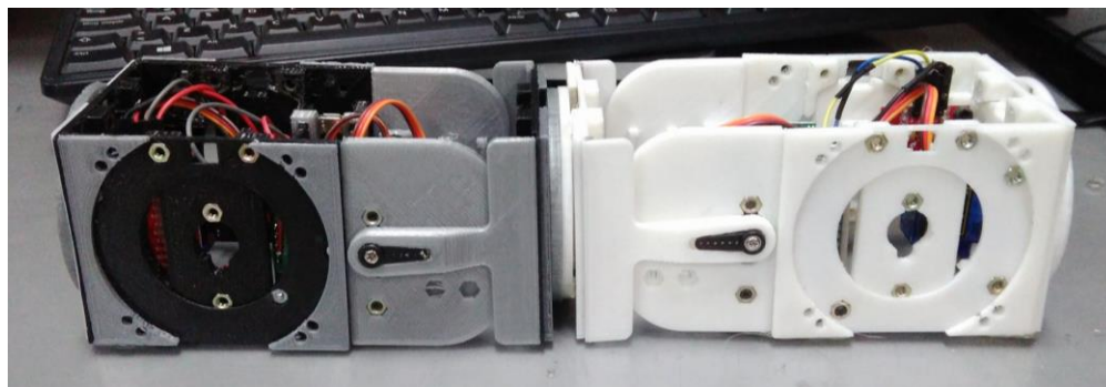
Figura 6-8 Módulo MECABOT 3.0 configuración oruga conexión pivote – pivote
