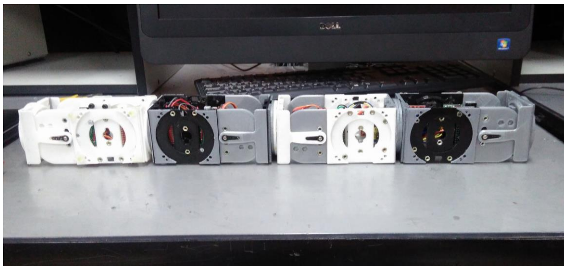
Figura 6-10 Módulo MECABOT 3.0 configuración oruga conexión centro – centro
