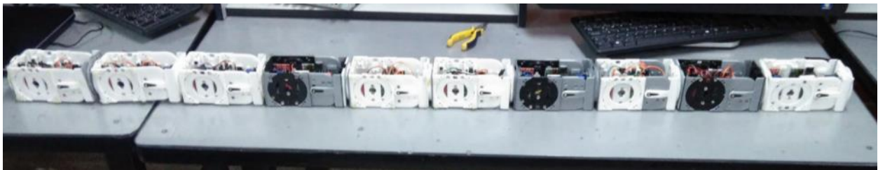
Figura 5-12 Construcción 10 semi-módulos MECABOT 3.0
