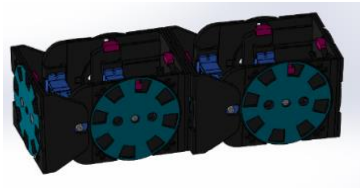
Figura 4-4 Módulo en configuración Pivote – Centro posición vertical (configuración oruga)
