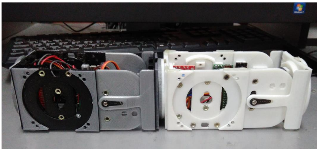
Figura 6-3 Módulo configuración oruga conexión pivote – centro
