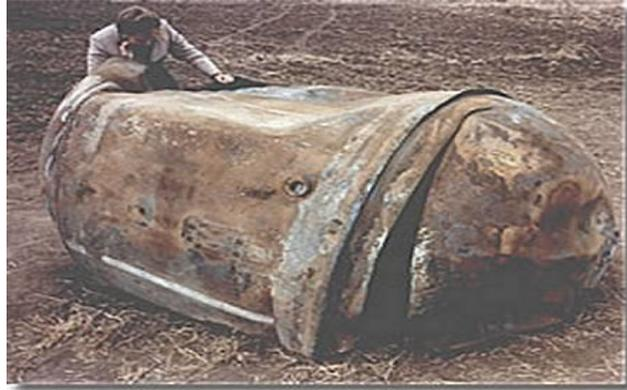
Figura 7. NASA - Tanque del propulsor principal de la segunda etapa de un Delta 2, 1997
