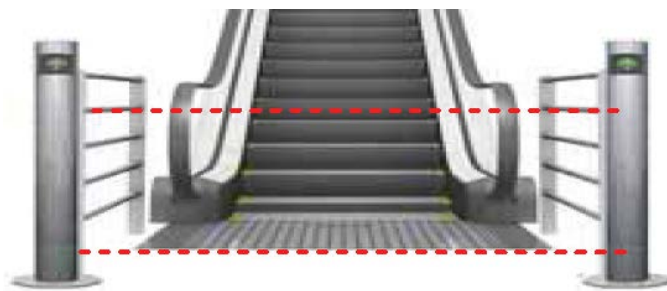
Figura 31. Detección del usuario por medio de sensores fotoeléctricos de laser
