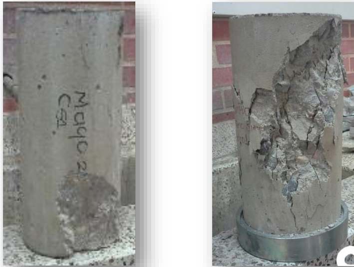
Figura 34. Cilindros CS fallados a compresión
