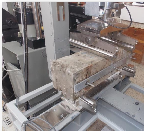
Figura 28. Esfuerzo a la flexión, viga sobre marco de carga
