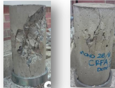
Figura 1. CS y CRFA fallados a compresión
