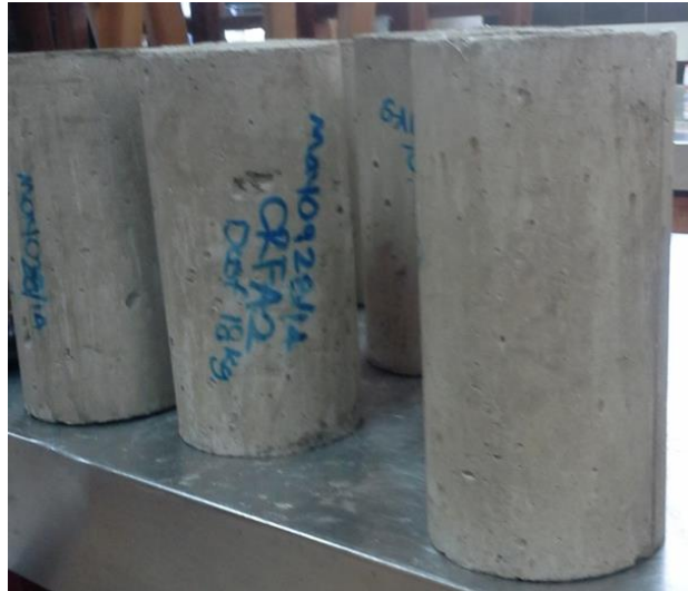
Figura 20. Cilindros para ensayo a compresión
