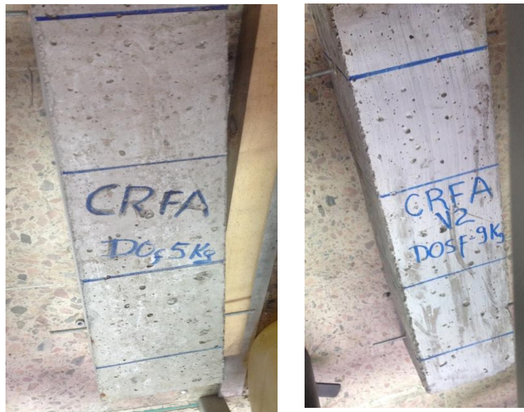
Figura 27. Esfuerzo a la flexión, L/3 en vigas CRFAD5-V1 CRFAD9-V2
