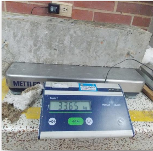
Figura 14. Peso de la viga perforada
