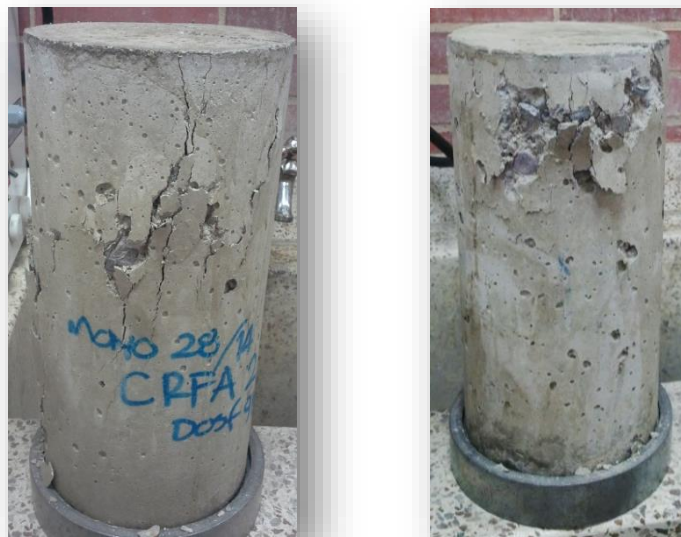
Figura 35. Cilindro dosificación 9 kg/m3 fallado a compresión
