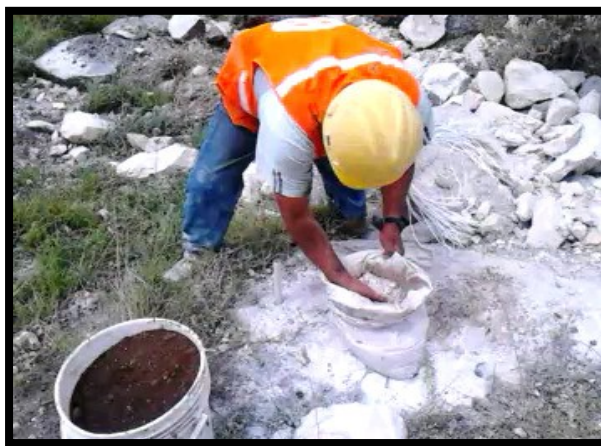
Ilustración 22 Manipulación inadecuada de explosivos artesanales fuente propia
