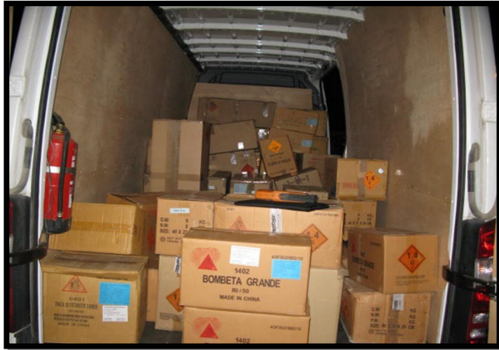
Ilustración 39 forma inadecuada de almacenar explosivos fuente [CITATION htt16 \]
