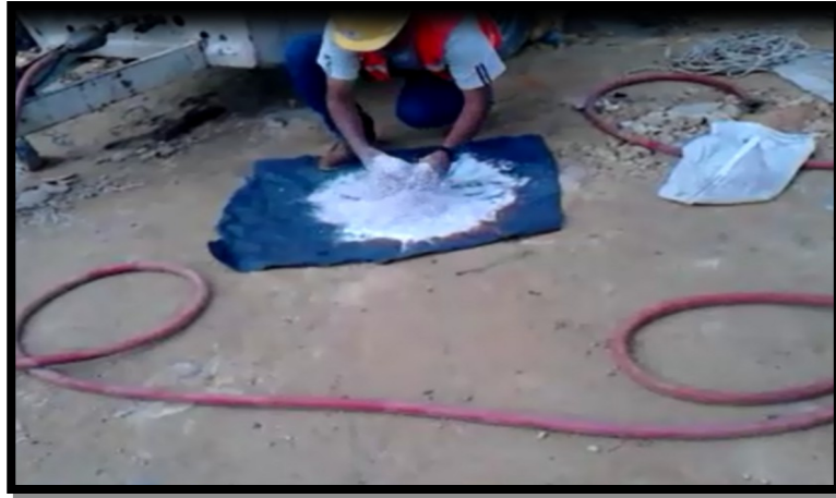
Ilustración 20 Mezcla de Nitrato de Amonio y combustible diésel fuente propia
