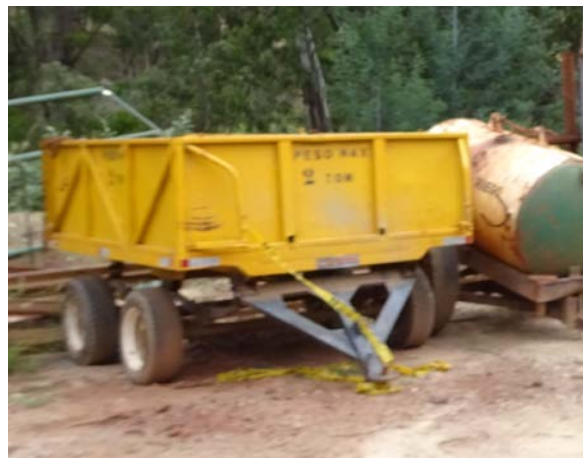
Figura 25 Tolva para transporte de material, y retiro de residuos
