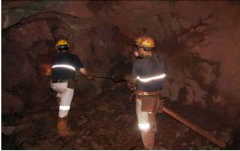
Figura 42. Perforación manual de un frente.
