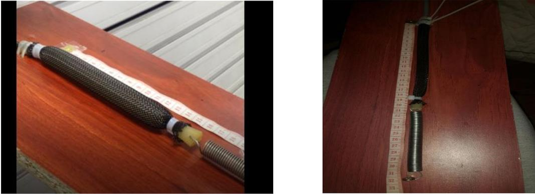
Figura 29 a) Músculo con carga y presión b) Músculo con carga sin presión
