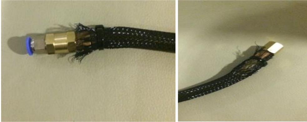
Figura 68 Terminales del músculo Neumático
