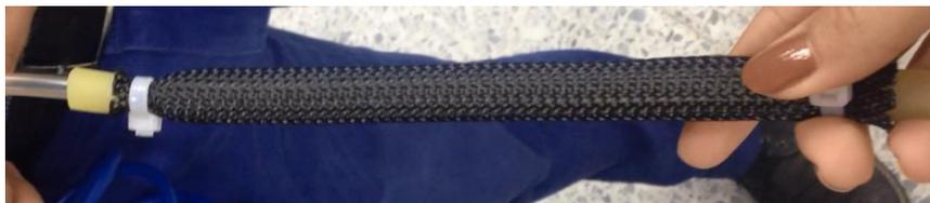
Figura 25 Prototipo músculo neumático final en prueba de presión
