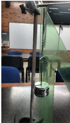
Figura 26 Montaje Caracterización del resorte
